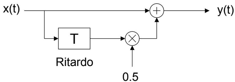
Calcolare e disegnare la funzione di Trasferimento del sistema quando  $T = 0.25$  sec
